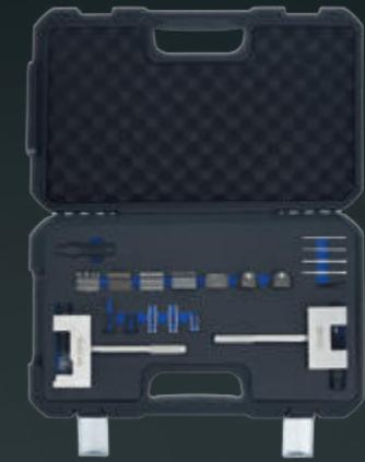
**SW STAHL** OUTIL DE CONTRÔLE DE LA CHAÎNE DE DISTRIBUTION, BMW / MINI
